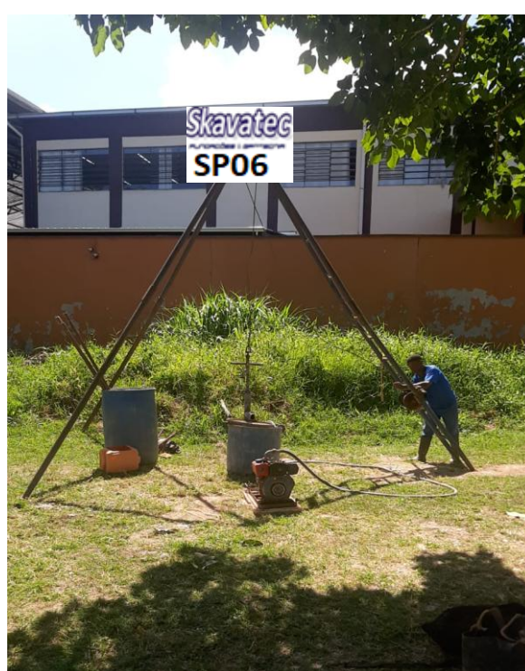
Foto 6 - Equipamento de Sondagem em Operação
