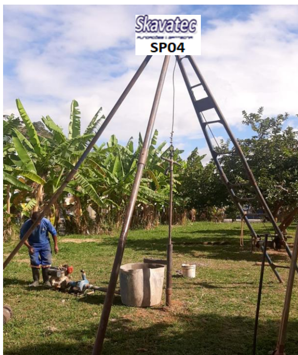
Foto 4 - Equipamento de Sondagem em Operação
