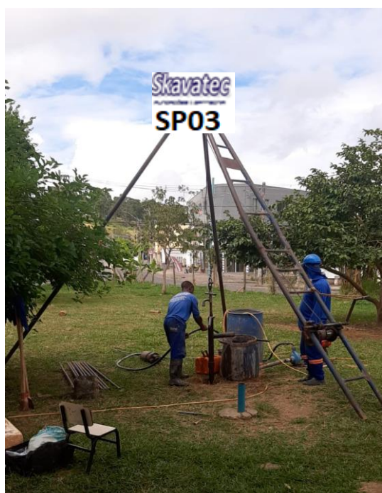
Foto 3 - Equipamento de Sondagem em Operação
